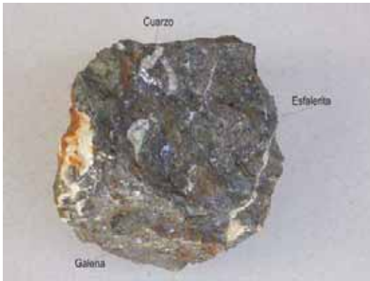
FOTO 150. Muestra de mano de la mineralización (esfalerita con pequeñas cantidades de cuarzo y galena). De derecha a izquierda la muestra fotografiada mide 8 cm.
