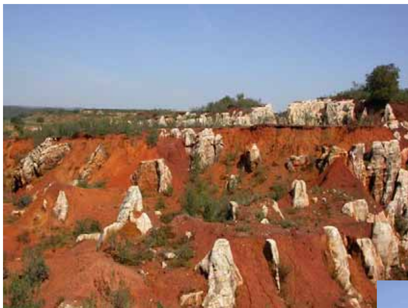
FOTO 161. Aspecto de la explotación minera en la que se observa como la extracción selectiva de la mineralización de óxidos de hierro que rellena los huecos actuó como un factor decisivo en el modelado definitivo de paisaje.
