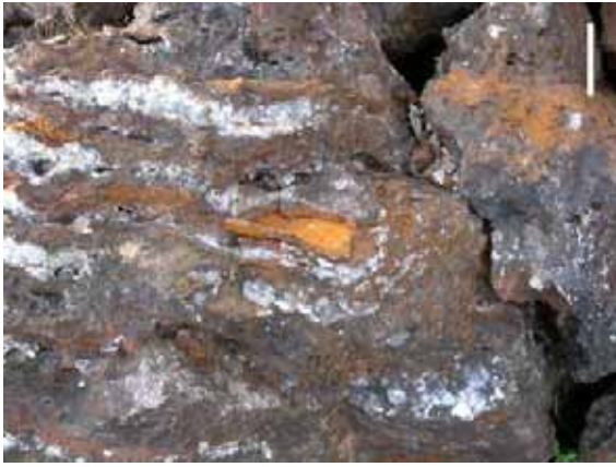
FOTO 162. A la izquierda, fotografía de detalle de la mineralización, compuesta esencialmente por óxidos de hierro con barita y carbonatos como ganga más significativa. Barra escala en la esquina superior derecha 3 cm.
